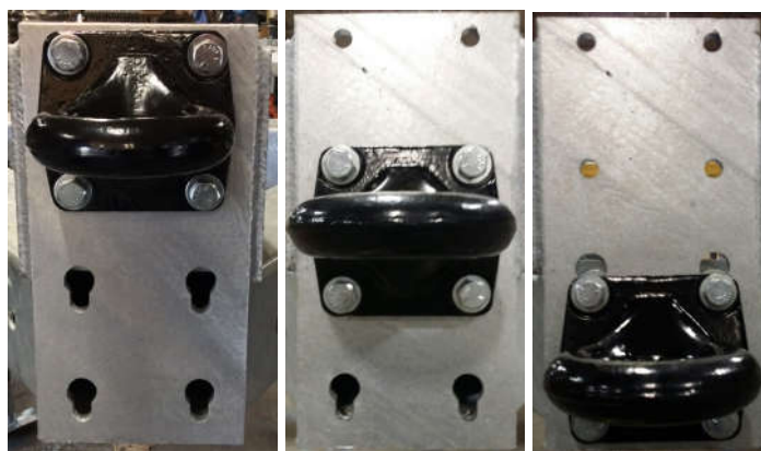
Figure 6. Positions d'installation de l'anneau d'accrochage
