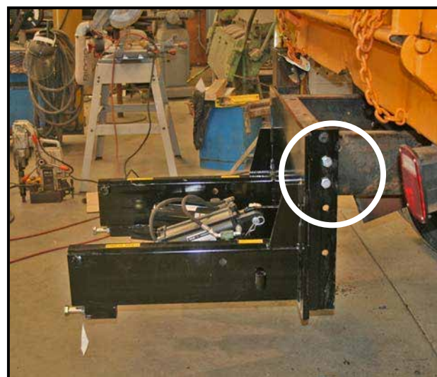
Figure 6. Boulonnage de la structure de support.
