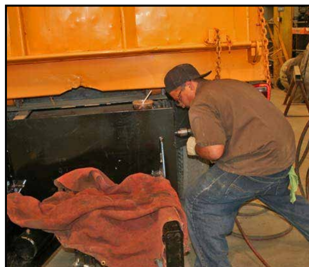
Figure 5. Perçage de trous dans les longerons de cadre de châssis.
