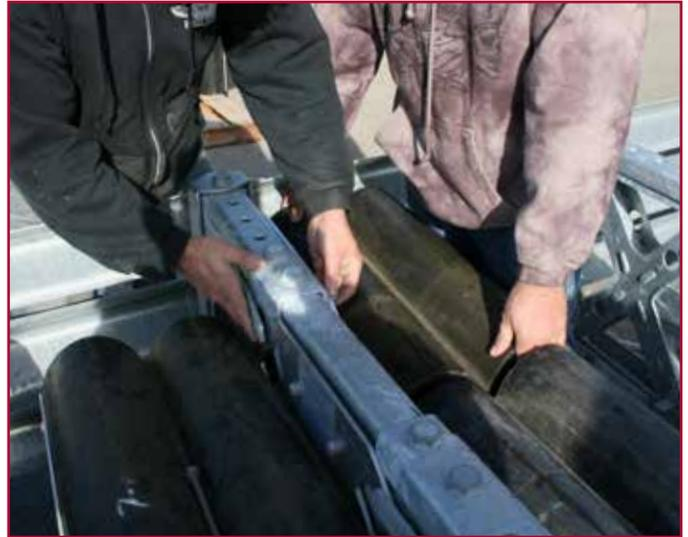
**Fixation des cartouches amortisseur à l'aide du support de fixation**
