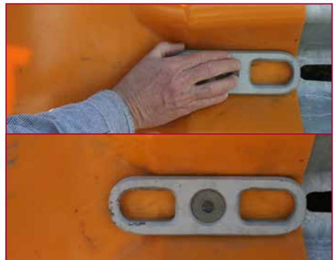
Installation des crochets de remorquage sur le couvercle du nez de raccord
